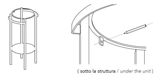
2 - Forare la parete nel punto segnato e inserire il tassello nel foro. Please drill the marked hole and insert the bolt into the hole.
